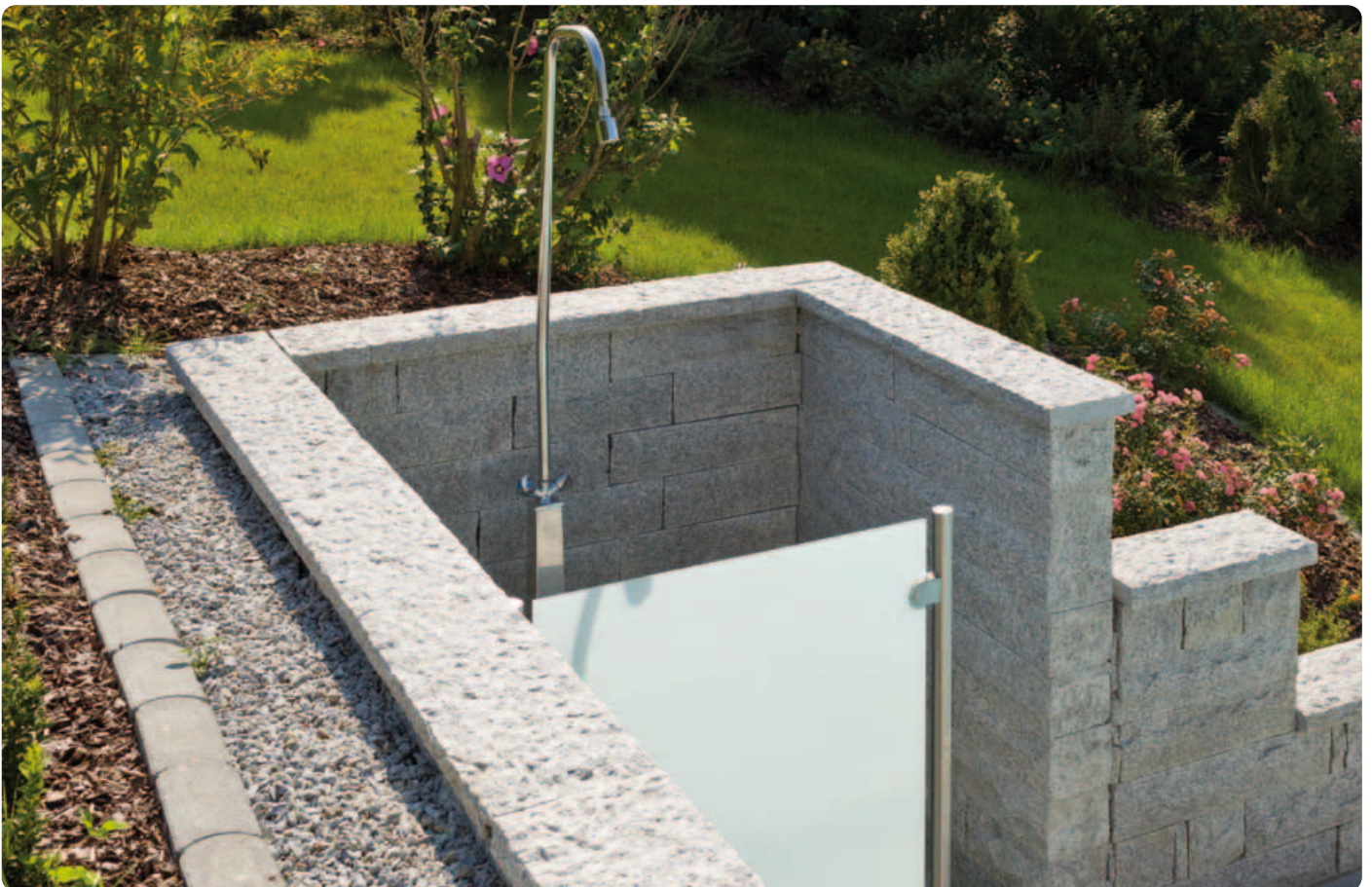
Naturstein Norm-Mauerabdeckung Rustika aus Granit C 015, Oberfläche gespalten und gespitzt, beide Längskanten gespalten mit Wassernase
