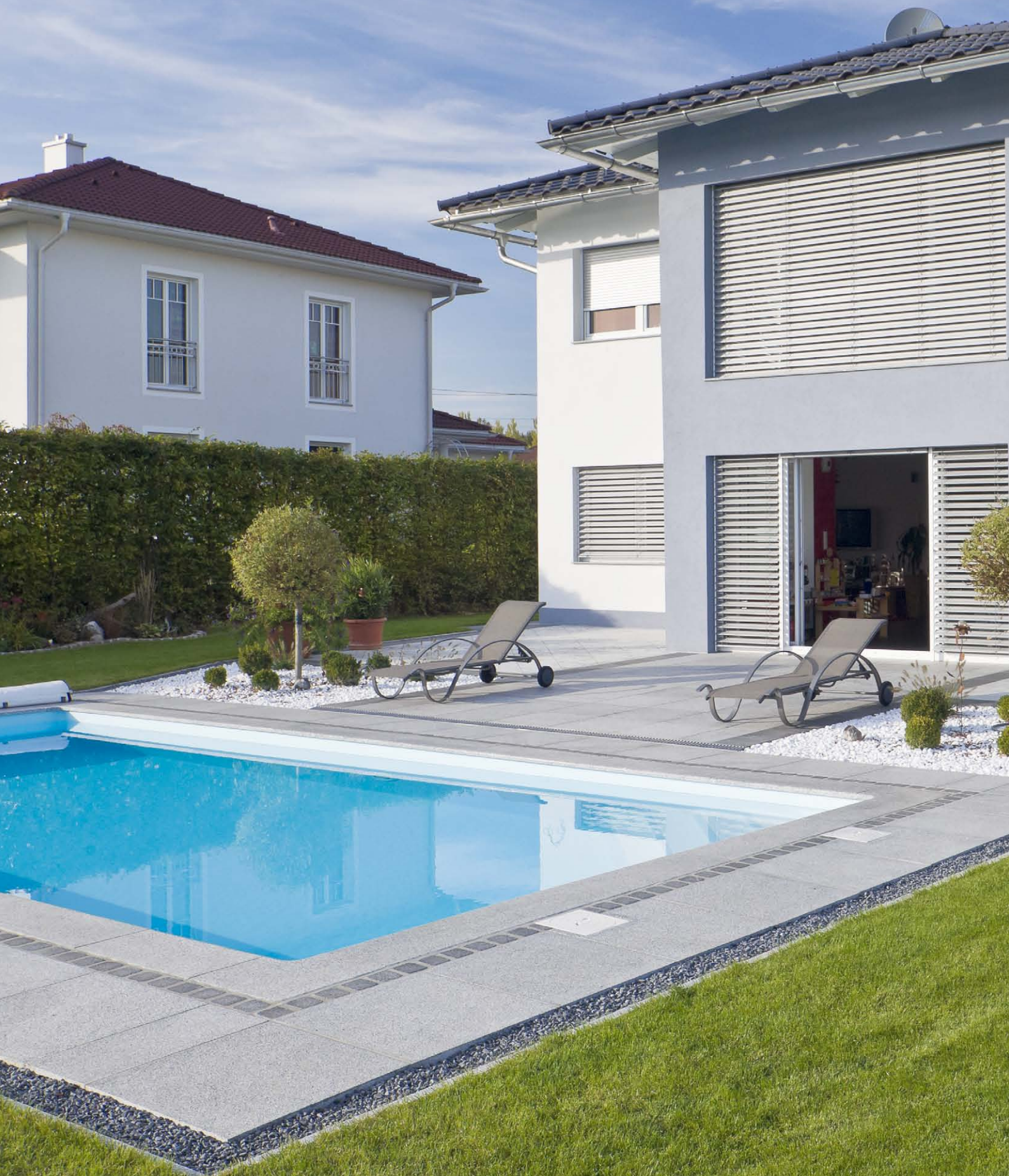
Naturstein Norm-Schwimmbadumrandung Exklusiv aus Granit C 020, Oberfläche geflammt, Innen abgerundet r=15\text{ mm} , außen gefaste Kante
