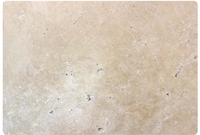
Travertin Classic Mix, Oberfläche offenporig, geschliffen und getrommelt
