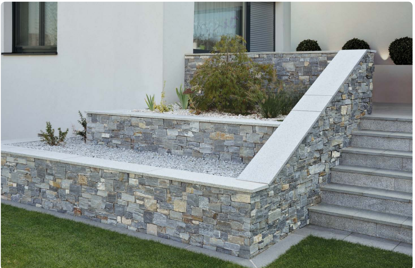
Naturstein Norm Mauerabdeckung Exklusiv aus Granit C 020, Oberfläche geflammt, beide Längskanten mit Wassernase und Fasen
