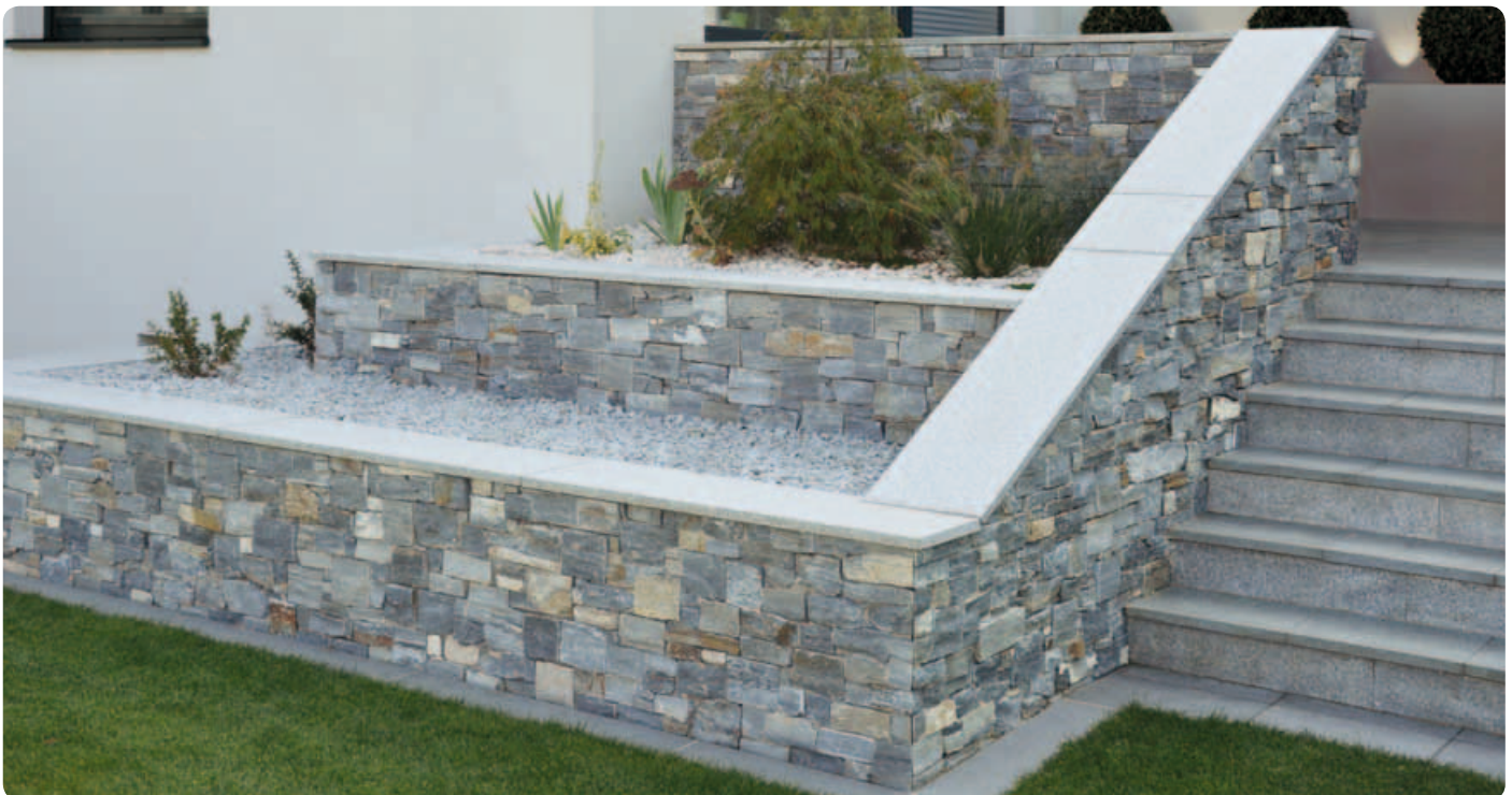
Naturstein Norm Mauerabdeckung Exklusiv aus Granit C 020, Oberfläche geflammt, beide Längskanten mit Wassernase und Fasen
